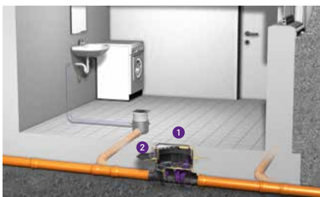
1 Válvula antirretorno 2 Conjunto de juntas de vedação
