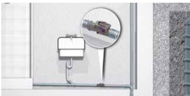
Tubo de drenagem exposto Ø 50 ou Ø 75
