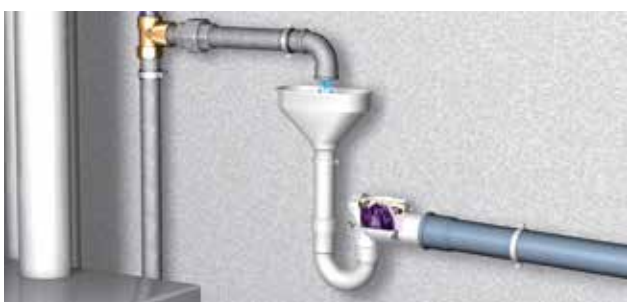
Lavatórios com sifões e ligação para máquina de lavar
