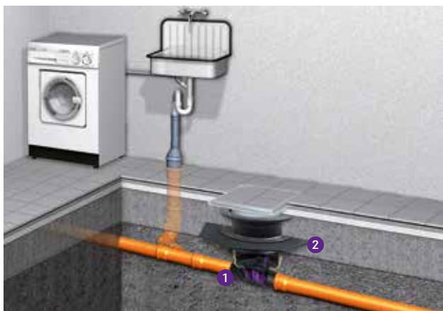
1 Válvula antirretorno 2 Secção de extensão
