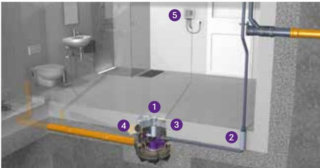
1 Estación elevadora 2 Juego de tubería de presión 3 Sección de extensión 4 Juego de juntas 5 Unidad de control
