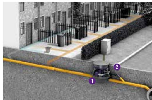
1 Estación elevadora híbrida 2 Tubería de presión
